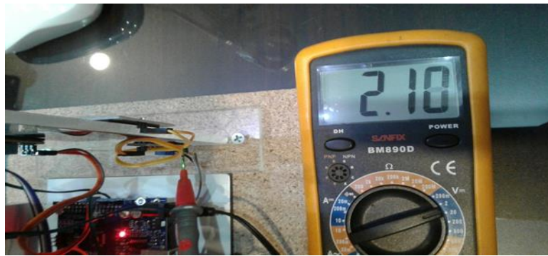
Gambar 9 Pengukuran output sensor hujan (rain gauge)
